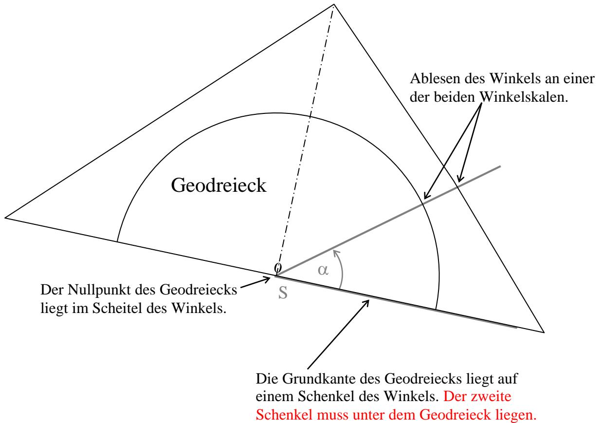
Winkel, die größer als  $180^\circ$  sind, lassen sich mit dem Geodreieck nicht direkt messen. Stattdessen misst man den zweiten Winkel, der von den beiden Schenkeln eingeschlossen wird und kleiner als  $180^\circ$  ist. Den gemessenen Wert subtrahiert man anschließend von  $360^\circ$ .
